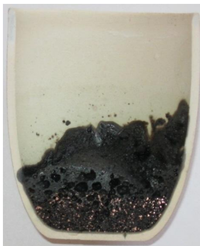
8 Сурет – 1300 °С температурада бастапқы шлак үлгісін синтездеу кезінде металды мыс түзілуі
